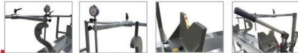
Mikrometre tutma aparatı (Opsiyonel Ekipman) Indicator holder apparatus (Optional Tool)
