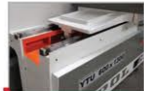
Linear kızaklar ( X eksen) Linear slides (X axis)
