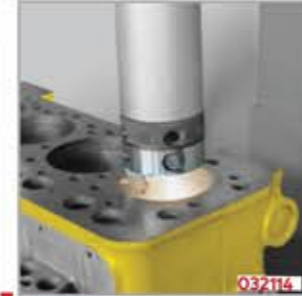
Silindir merkezleme aparatı, silindir merkezini kolayca bulmanızı sağlar. Cylinder centering device supplies you to find the centre of the cylinder.
