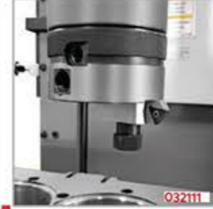
Havşa kalemi, silindir ağzına havşa açmanızı sağlar. Chamfering a cylinder with the chamfering tool.
