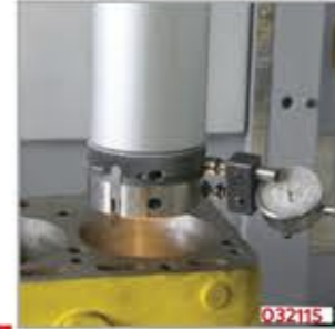
Paso verme aparatı, işleyeceğiniz çapı ayarlayıp talaş (paso) verabilirsiniz. Tools setting device (without dial gauge) Adjusting the diameter you may boring the engine block.
