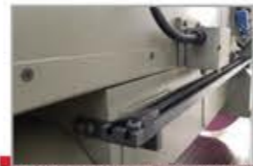
İleri/geri hareketi sınır siviçleri ( Y eksen) Forward/backward movement limit switches(Y axis)
