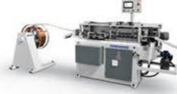
Tel ve Bakır Çubuk Doğrultma ve Kesme Makinesi Wire Copper Rod Straightening and Cutting Machine
