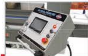
Dokunmatik ekran ve kontrol ünitesi Touch screen and control unit
