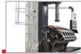
Dik sütun servis merdiveni Z axis column service stairs
