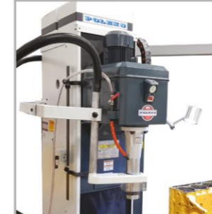
Talaş vakum sistemi, kesme işlemi sırasında çıkan toz ve ta- laşları tahliye etmekte yardımcı olur.(Opsiyonel Ekipman) Vacuum system, help to evacuate that dust and shavings while on boring process.( Optional tool)
