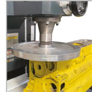
Dairesel çoklu yüzey frezeleme başlığı, CBN ve PCD elmaslar için uygundur. (Opsiyonel Ekipman) Circular multiple surface milling head, suitable for CBN and PCD type cutters. (Optional Tool)
