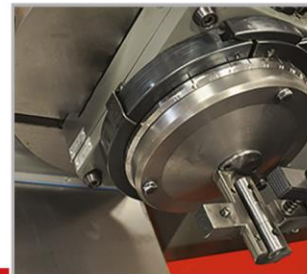
Çap göstergesi ve cetveli Diameter indicator
