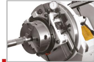
Strok kontrolü için ölçü saati aparatı Measurement attachment holder place for control the strokes
