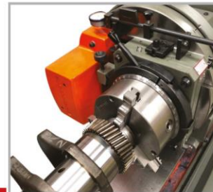
Strok ölçü aparatı tutkacı Strock control masurement attachment holder
