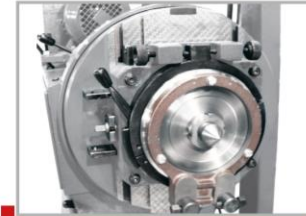
İş kafası üzerine punta bağlantısı. Centre connection on work head
