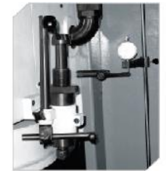
Paso verme ve taş bileme aparatı Precision incremental in feed and wheel grinding apparatus
