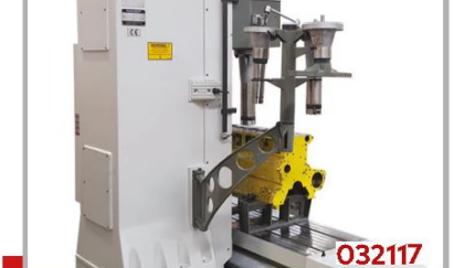
Başlık değıstirme robotu (Opsiyonel Ekipman) Boring head changer robot (Optional Tool)
