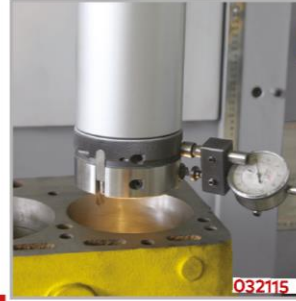
Paso verme aparatı, işleyeceğinin çapı ayarlayıp talaş (paso) vere- bilirsiniz. Tools setting device (without dial gauge) Adjusting the diameter you may boring the engine block.
