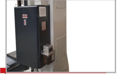
Elektrik panosu soğutma ve havalandırma sistemi Electric panel fan and ventilation system
