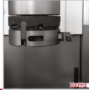
Silindiri merkezledikten sonra, rektefiye edebilirsiniz After centring the cylinder, you can bore the inside of cylinder.
